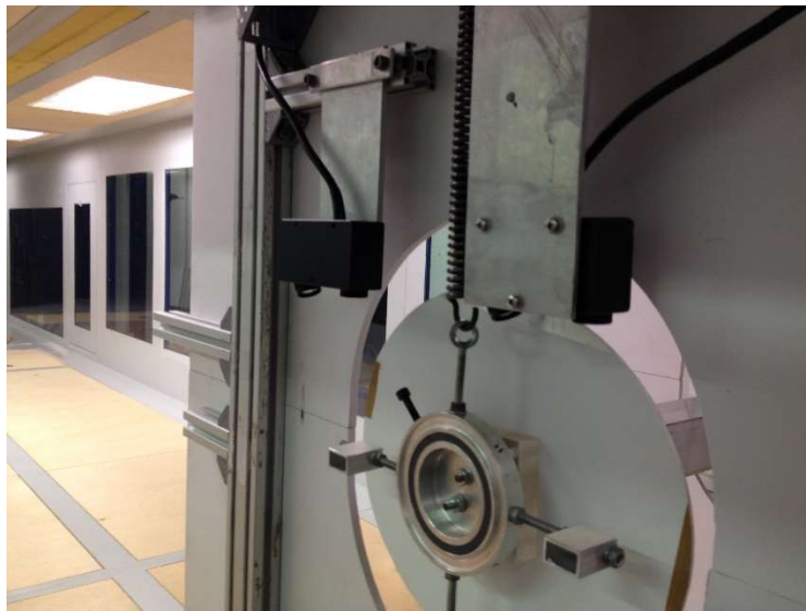
Figura 4.7 Particolare dei laser montati
