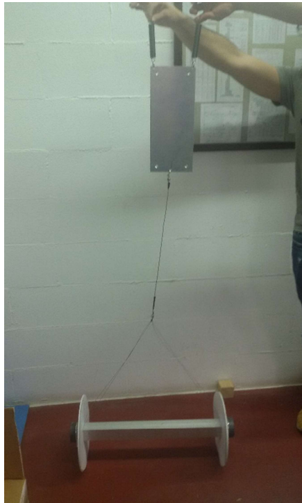
Figura 4.4 Corpo oscillatore collegato alla piastra d'alluminio
