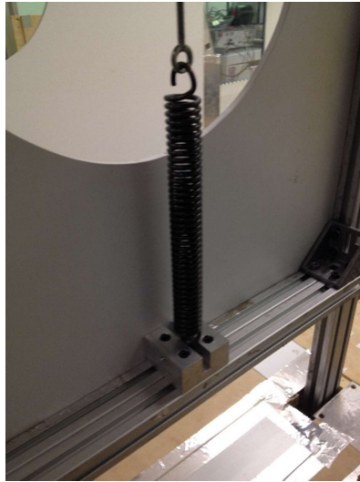
Figura 4.3 Particolare degli agganci inferiore e superiore delle molle alle traverse
