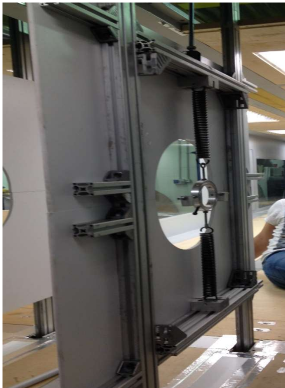
Figura 4.2 Vista in prospettiva del setup dove si possono osservare due dei quattro profilati verticali e due traverse orizzontali. Si noti inoltre il complesso molla-boccola-molla
