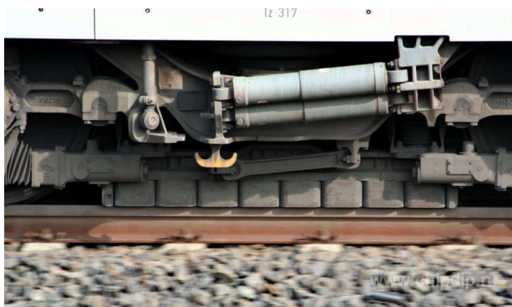
Figura 2.3 Applicazione del freno magnetico lineare in ambito ferroviario
