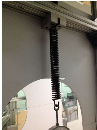
Figura 4.3 Particolare degli agganci inferiore e superiore delle molle alle traverse
